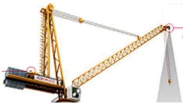
Figuur 5.4.5-2 Camerasysteem in een top-torenkraan
