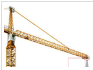
Figuur 5.4.5-1 Camerasysteem in een loopkat-torenkraan
